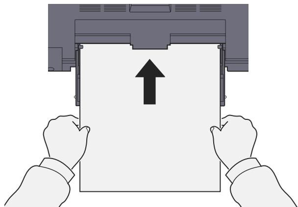
沿着纸张宽度导板将纸张在托盘中插入到底。
