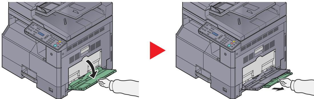
拉出手送纸盘延伸架以符合纸张尺寸。打开手送纸盘时请参阅贴于机器内部的标签。
