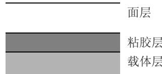
如图所示, 标签纸含有三层。粘胶层内含有的物质容易受机器内施加的力的影响。使用标签纸之前, 载体层一直承接着面层。标签纸的这种构造可能会导致很多故障。
